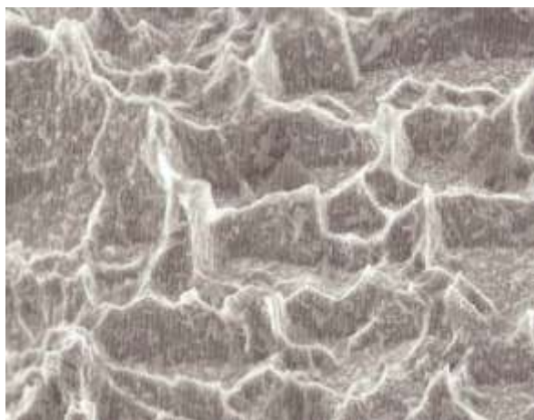
Figure 32. a) Le dépôt Nanotite au microscope électronique à balayage avec un grossissement \times 20.000 ) (Mendes et coll., 2007) (74)
