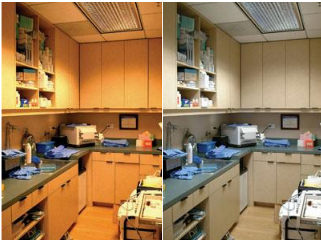
Fig. 30 Comparaison entre un éclairage Tungstène à gauche (3000 K) et un éclairage de type lumière du jour (5500 K) à droite. D'après ZADEH (50)
