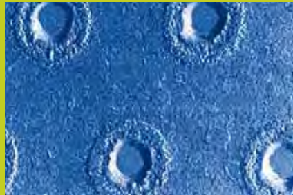
Les membranes BoneShield FRIOS®, perforées au laser, sont perméables à l'oxygène et aux cellules de défense, qui peuvent migrer sans obstacle.
