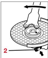
Ne jamais desserrer un écrou de serrage rapide bloqué au moyen d'une pince, mais utiliser une clé à ergots.
